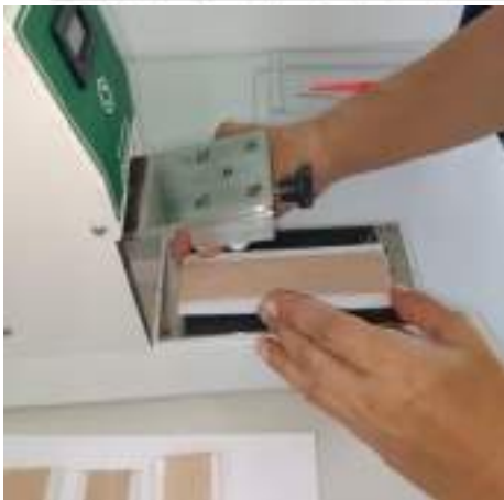
เครื่อง Crocktec Colour Fastness Tester ใช้ทดสอบความคงทนต่อการซัก
