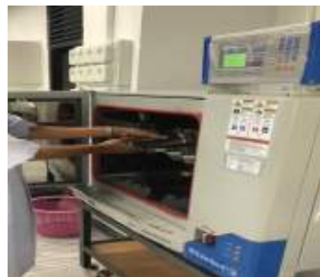
เครื่องIR (Infrared Rays) Dyeing Machineใช้ทดสอบ ความคงทนต่อการซัก
